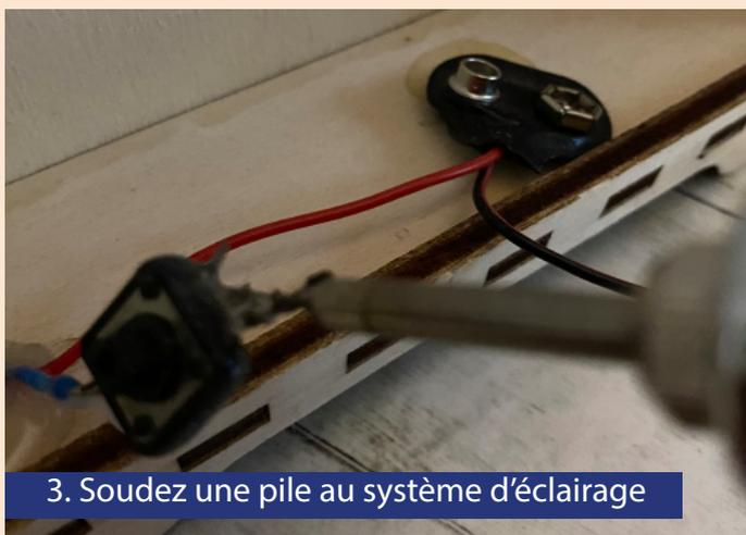
3. Soudez une pile au système d'éclairage
